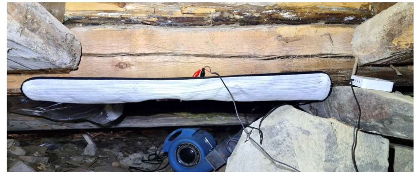
InfraVivo IR Torkfilt - fälttest Krypgrund
